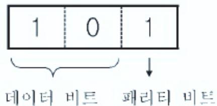
전송된 비트 3개 한 묶음에서 2개의 데이터 비트 중 값이 1인 비트의 수가 짝수인데 패리티 비트의 값이 1이거나, 2개의 데이터 비트 중 값이 1인 비트의 수가 홀수인데 패리티 비트의 값이 0이면, 전송 중 오류가 발생한 것으로 판정한다. 이와 같은 데이터 오류 검사를 패리티 검사라 한다.
