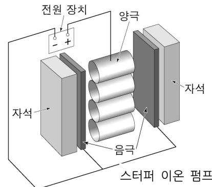
자기장은 전자가 양극까지 이동하는 거리를 자기장이 없을 때보다 증가시켜 주어 전자와 기체 분자와의 충돌 빈도를 높여 준다. 이 과정에서 생성된 양이온은 전기력에 의해 음극으로 당겨져 음극에 박히게 되어 이동 불가능한 상태가 된다. 이 과정이 1차 펌프 작용이다. 또한 양이온이 음극에 충돌하면 타이타늄이 떨어져 나와 충돌 지점 주변에 들러붙는다. 이렇게 들러붙은 타이타늄은 높은 화학 반응성 때문에 여러 기체 분자와 쉽게 반응하여, 떠돌아다니던 기체 분자를 흡착한다. 이는 떠돌아다니는 기체 분자의 수를 줄이는 효과가 있으므로 이를 2차 펌프 작용이라 부른다. 이렇듯 1, 2차 펌프 작용을 통해 스퍼터 이온 펌프는 초고진공 상태를 만들 수 있다.
